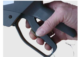
Abb.1. Untersuchung der Betätigungskräfte bei einem Handetikettierer
