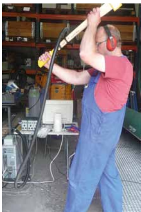
Abb.9. Schwingungsmessung an Spaltäxten
