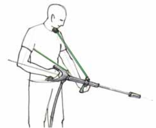
Abb.1. Untersuchung der Betätigungskräfte bei einem Handetikettierer
